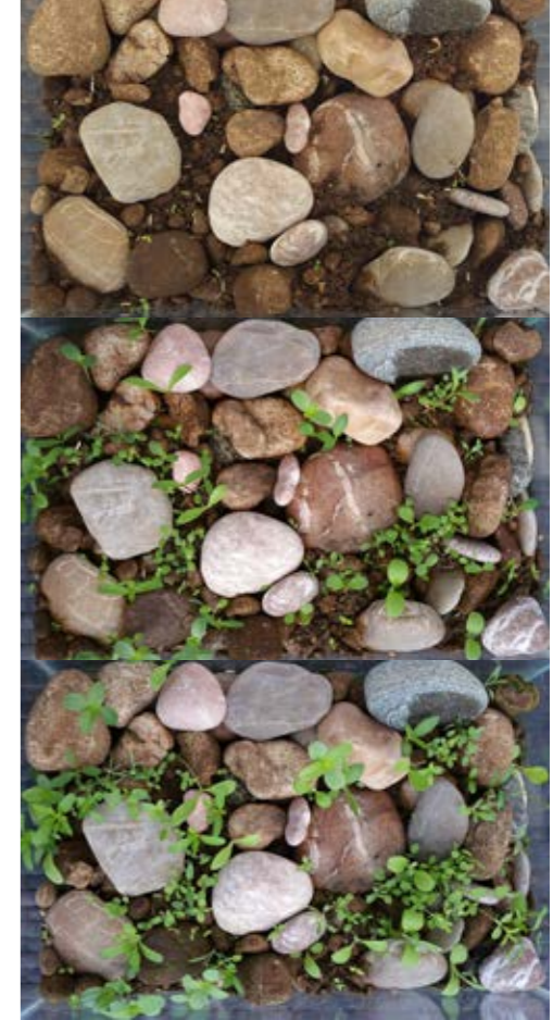
Vegetationsprojekt: Wie viel Schotter ist zu viel Schotter? Befüllung mit etwa 75 % Schotter und 25 % nährstoffarmer Erde; Saatgut für Wildblumen und Gräser
